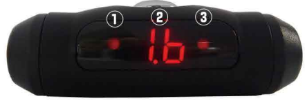
ディスプレイユニット正面 (障害物までの距離等を表示します)
