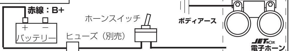
※電子ホーンの取付は、本体を確実にボディアースが取れる場所に取り付けるか、本体に配線を設けてアースしてください
