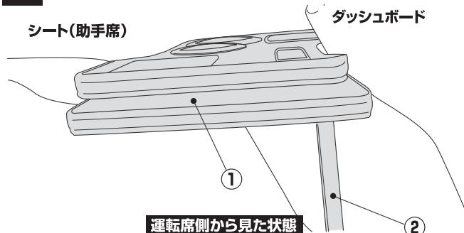
**4** テーブル面が水平になるように②の高さ調整ネジでテーブルの高さを適切な位置に調整します。
